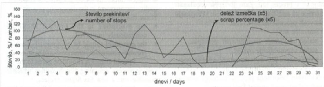
Sl. 7. Analiza količine izmečka ter prekinitev tlačnega litja na stroju, krajših kot 10 minut
