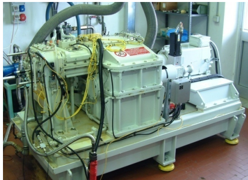
Slika 4. Preizkuševališče za karakterizacijo zobnikov za letalsko in vesoljsko industrijo
