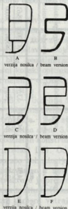
Sl. 5. Skice obdelanih prečnih rezov odbojnika tipa dušilka + nosilo [11]
