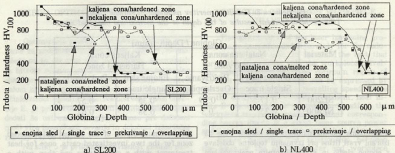
Sl. 6. Rezultati meritev mikrotrdote materiala modificiranega sloja na obdelovancu pri enojni sledi in pri več sledeh s prekrivanjem nataljenih sledi
