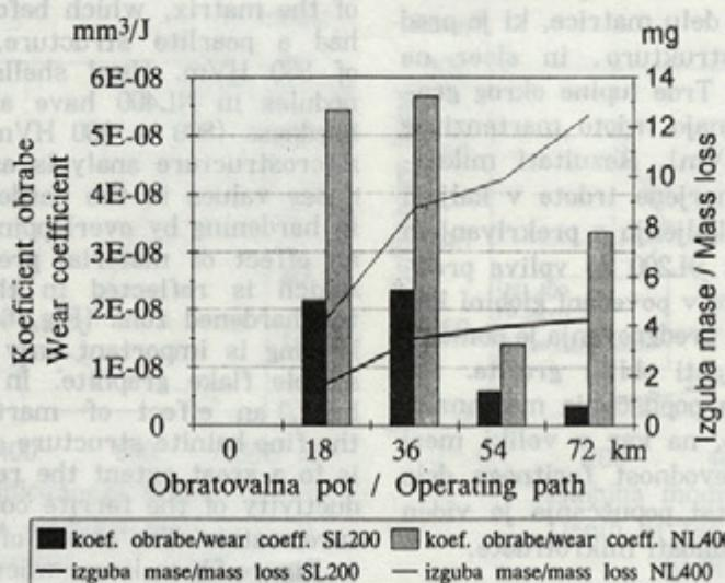
Sl. 7. Izguba mase in koeficient obrabe litin SL200 in NL400 z lasersko nataljeno površino s prekrivanjem nataljenih sledi v drsnem kontaktu s kaljenim jeklom za poboljšanje Č1531 (ISO Ck45)
