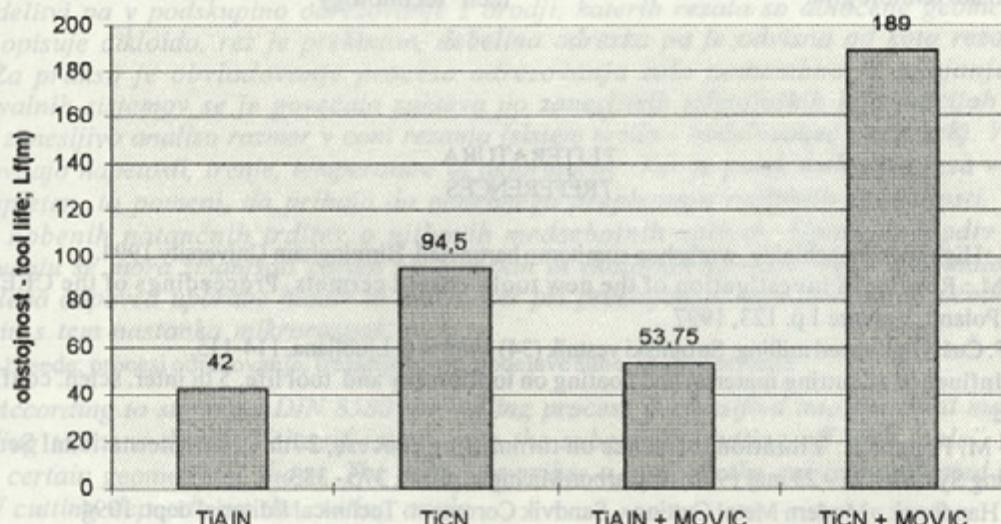
Sl. 8. Primerjava obstojnosti orodij pri frezanju z različnimi tipi prevleke - chip. Fig. 8. Tool life comparison when end milling with different coatings
